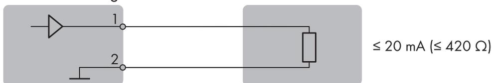
Figura 10: Collegamento di un dispositivo remoto analogico
