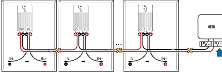
**JP** PVストリングのケーブル極性を判断します。
