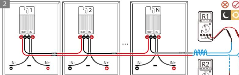
**CS** Je-li napětí fotovoltaického řetězce menší než 1 V, změřte odpor fotovoltaického řetězce a zajistěte, aby  $(R1 + R2)/2 \text{ k}\Omega \approx N \times 1 \text{ k}\Omega$ . Například, má-li fotovoltaický řetězec 16 optimalizátorů, měl by být jeho odpor zhruba 16 k\Omega.
