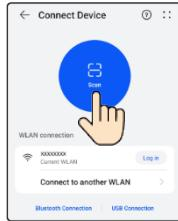
**NB** Logg på FusionSolar-appen som installatør. Velg Services > Commission Device, og koble til WLAN-sonen til omformeren.
