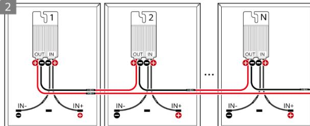
**ES** Cuando el voltaje del string FV sea inferior a 1 V, mida la resistencia del string FV y asegúrese de que  $(R1 + R2)/2 \text{ k}\Omega \approx N \times 1 \text{ k}\Omega$ . Por ejemplo, si un string FV tiene 16 optimizadores, su resistencia debería ser de aproximadamente 16  $\text{k}\Omega$ .
