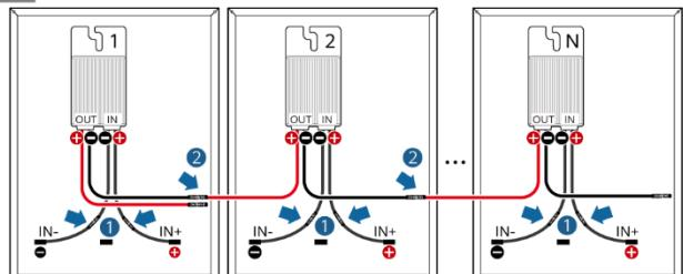
JP オプティマイザ入力をPVモジュールに接続し、オプティマイザ出力を接続して、PVストリングを形成します。
