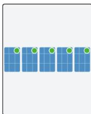
**EL** Συνδεθείτε στην οθόνη θέσης του αντιστροφέα σε λειτουργία ως υπεύθυνος εγκατάστασης, επιλέξτε Monitor, επιλέξτε τη Φ/Β στοιχειοσειρά και ελέγχετε την κατάσταση του βελτιστοποιητή.
