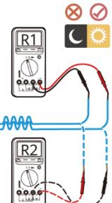
**PL** Kiedy napięcie łańcucha PV jest mniejsze niż 1 V, należy zmierzyć rezystancję łańcucha PV i upewnić się, że  $(R1 + R2)/2 \text{ k}\Omega \approx N \times 1 \text{ k}\Omega$ . Na przykład, jeśli łańcuch PV ma 16 optymalizatorów, rezystancja łańcucha PV powinna wynosić około 16 kΩ.
