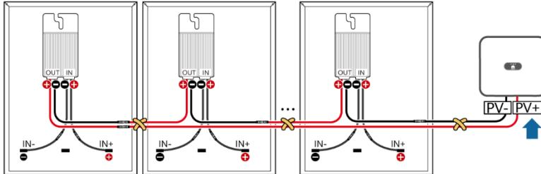
**NB** Fastslå PV-strengkabelens polaritet.
