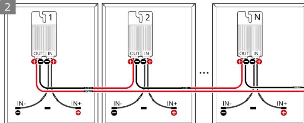
**LV** Ja fotoelementu spriegums ir mazaks par 1 V, izmēriet fotoelementu ķēdes pretestību un raugieties, lai  $(R1 + R2)/2 \text{ k}\Omega \approx N \times 1 \text{ k}\Omega$ . Piemēram, ja fotoelementu ķēdeli ir 16 optimizētāji, fotoelementu ķēdes pretestībai būtu jābūt aptuveni 16 kΩ.
