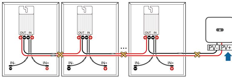
**NB** Koble PV-strenget til omformeren først etter at du har sikret at PV-strengeppningen er riktig. Ellers kan optimererne bli skadet. Det anbefales å minimere avstanden mellom de positive og negative kablene til optimererne.
