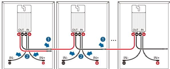
JP オプティマイザ出力を接続してPVストリングを形成してから、オプティマイザの入力をPVモジュールに接続します。
