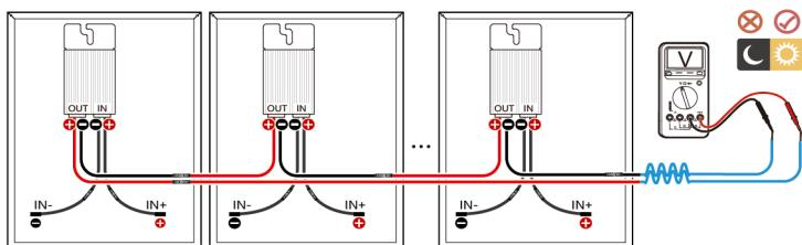
JP マルチメーターを使用してPVストリングの電圧を測定します。各PVモジュールの電圧は1V（許容誤差：±5%）とし、PVストリングの電圧値（許容誤差：±5%）はストリング内のオプティマイザの個数に等しいものとします。プローブが逆に接続されると、測定される電圧は負の値で示されます。PVストリングの電圧に異常がある場合は、ユーザーマニュアルを参照してケーブルの接続を確認してください。
