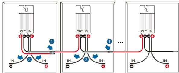
**NB** Kable til optimeringsutganger for å danne en PV-streng, og koble optimeringsinngangene til PV-modulene.
