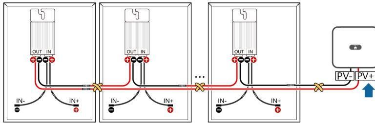
**JP** PVストリングの電圧が正しいことを確認した後のみ、PVストリングをPCSに接続します。そうしない場合は、デバイスが破損する可能性があります。オブティマイザの正負のケーブル間の距離を最小にすることを推奨します。
