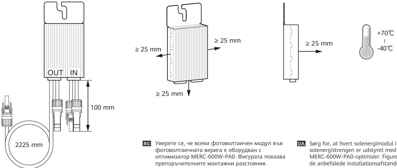
**BG** Уверете се, че всеки фотоволтаичен модул във фотоволтаичната верига е оборудван с оптимизатор MERC-600W-PA0. Фигурата показва препоръчелните монтажни разстояния.
