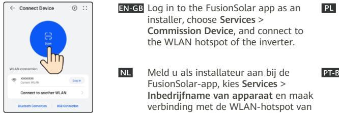
**PL** Zalogować się w aplikacji FusionSolar jako instalator, wybrać kolejno Ustugi > Przekazywanie urządzenia do eksploatacji i nawiązać połączenie z hotspotem WLAN falownika.
