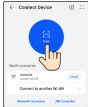
**NB** Logg på FusionSolar-appen som installator. Velg Services > Commission Device og koble til WLAN-aktiveringspunktet til omformeren.
