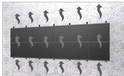
Sehr gute Hinterlüftung der Module
