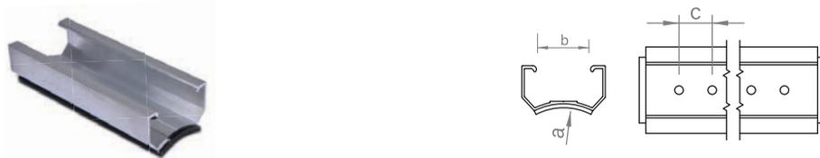
Kurzprofil mit Lochung Durchmesser 5,2mm und vorkonfektionierter Dichtung für Modulquermontage auf Wellblech, Radius 39,4mm. Die Montage erfolgt spanlos mit der Befestigungsschraube Trapez.
