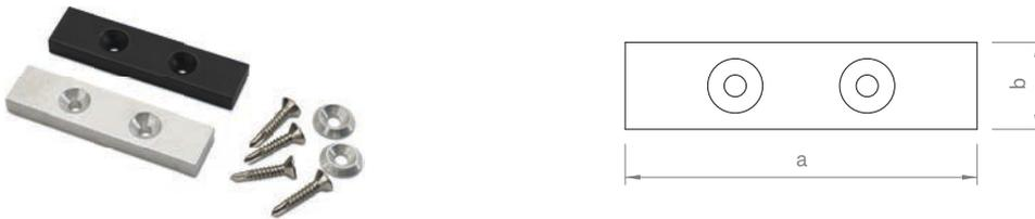
Adapterblech für die Sicherung der Module gegen Abrutschen und zur Befestigung von Lochblechen. Vorgefertigt mit zwei 5 mm Bohrungen für die Anbindung an den Sockel, sowie zwei Senkscheiben und vier Senkkopf-Bohrschrauben mit Torx 25 Antrieb.
