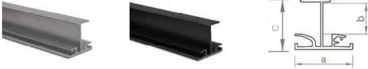
Einlegeschiene zum Einlegen von gerahmten Modulen mit einer Rahmenhöhe von 30–50 mm, wahlweise blank oder schwarz (sw) eloxiert erhältlich. Die tatsächliche Rahmenhöhe des Moduls entspricht dem angegebenen Maß b abzüglich 1,3 mm.
