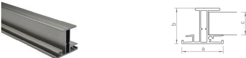
Einlegeschiene zum Einlegen von gerahmten Modulen mit einer Rahmenhöhe von 35 mm bzw. 40 mm für hohe Schneelasten mit der Möglichkeit ein Schneefangsystem anzubinden. Das Maß c gibt die Rahmenhöhe des Moduls an, die jeweilige Einlegeschiene hat zusätzlich 1,3 mm Raum, um das Modul einzulegen.
