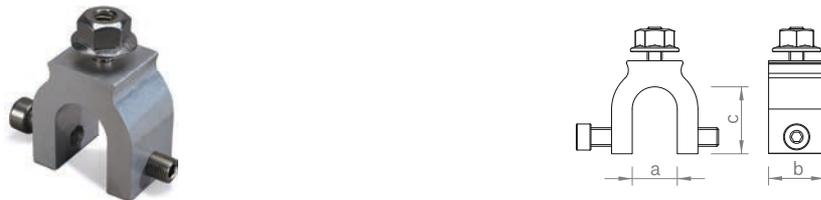
Klemme mit Maden- und Zylinderkopfschraube mit Innensechskant SW 5 für Rundfalzdächer und einer Sperrzahnmutter SW 18 zur Befestigung von C-Schienen. Alternative Verpackungseinheiten siehe S. 86.
