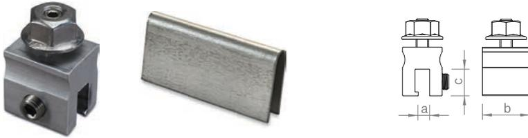
Klemme mit Madenschraube für Stehfalzdächer und einer Sperrzahnmutter SW 18 zur Befestigung von C-Schienen, wahlweise mit Edelstahlsattel zur Montage auf Kupferdächern. Alternative Verpackungseinheiten siehe S. 86.
