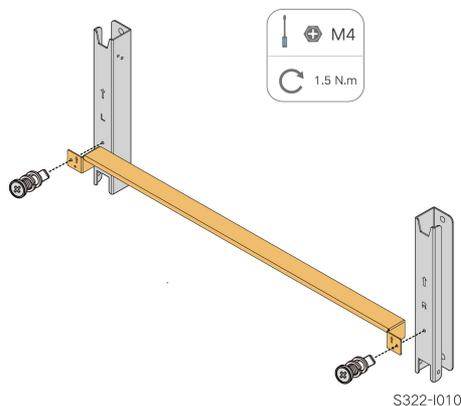
Étape 2 Mettez à niveau le support de montage assemblé en utilisant le niveau et marquez les positions pour percer des trous.
