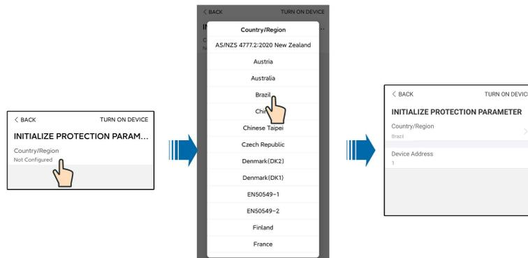
figure 7-3 Paramètre de protection de l'initialisation
