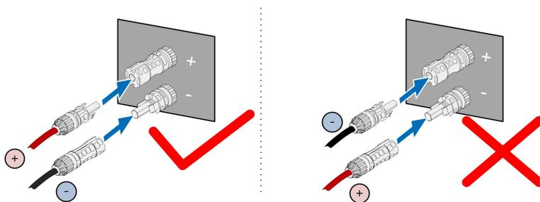
Étape 4 Respectez les étapes suivantes pour brancher les connecteurs PV d'autres chaînes PV.
