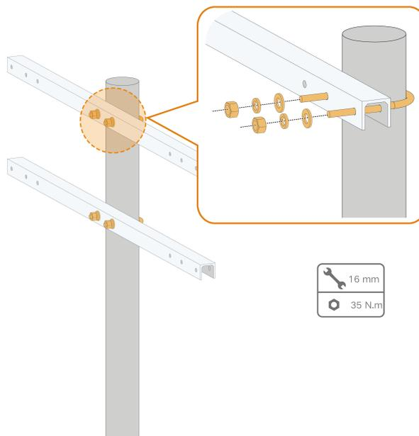
Étape 5 Utilisez des boulons pour fixer le support de montage à la poutre en U.
