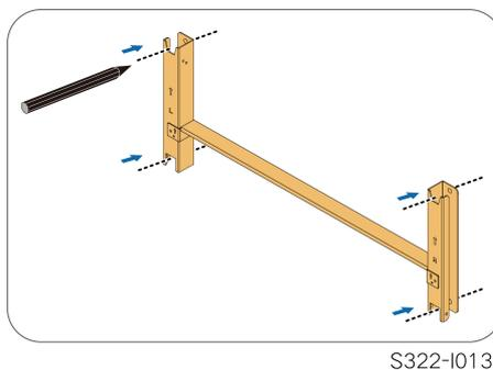
Étape 3 Insérez les boulons d'expansion dans les orifices et fixez-les avec un maillet en caoutchouc. Fixez l'écrou avec une clé pour dilater le boulon. Retirez l'écrou, la rondelle élastique et la rondelle plate et stockez-les correctement.
