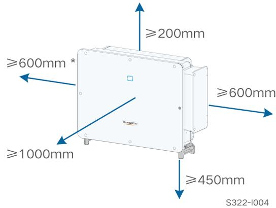
\* Si cette distance est inférieure à celle indiquée sur le schéma, déplacez l'onduleur du support de montage ou du mur avant de maintenir les ventilateurs.
