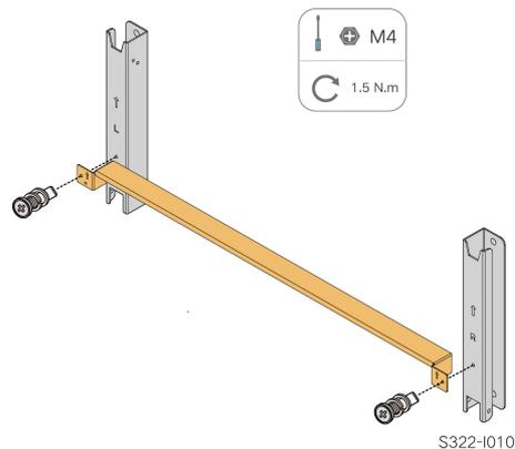
Étape 2 Mettez à niveau le support de montage assemblé en utilisant le niveau et marquez les positions pour percer des trous sur le support PV. Percez les trous en utilisant une perceuse électrique.
