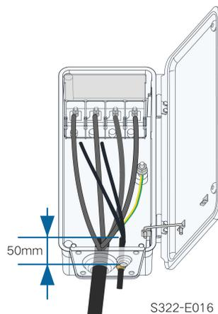
Étape 4 Placez les bornes OT du câble d'alimentation du système de suivi sur les bornes OT/DT du câble CA, et fixez-les.
