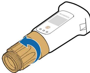
Étape 4 Faites passer successivement le câble réseau à travers l'écrou orientable et le joint. Ensuite, acheminez le câble dans l'ouverture du joint. Enfin, insérez le câble dans le boîtier.
