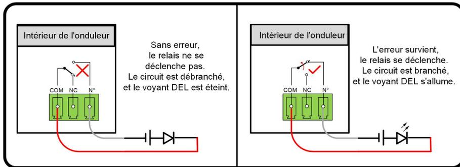
figure 5-8 Contact normalement ouvert
