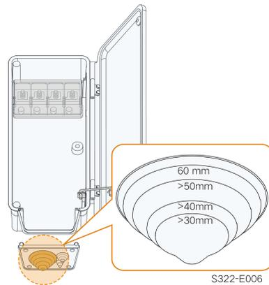
Étape 5 Faites passer le câble avec la couche protectrice dénudée à travers la bague d'étanchéité et fixez les vis sur la plaque d'étanchéité inférieure.
