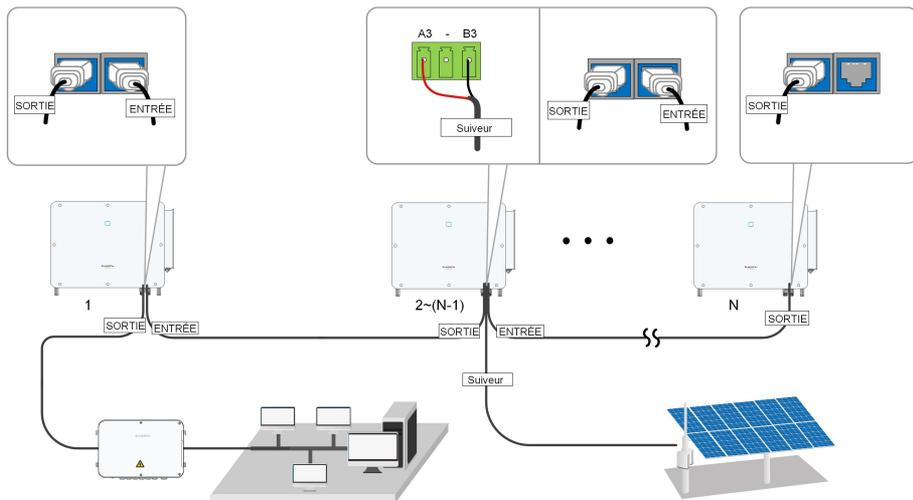
**figure 5-7** Système de communication à plusieurs onduleurs 【Interface RS485\_1 (RJ45)】
