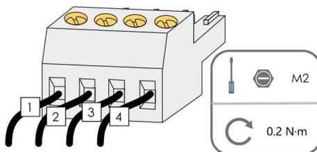
Étape 6 Insérez la prise de la borne dans le bornier correspondant.
