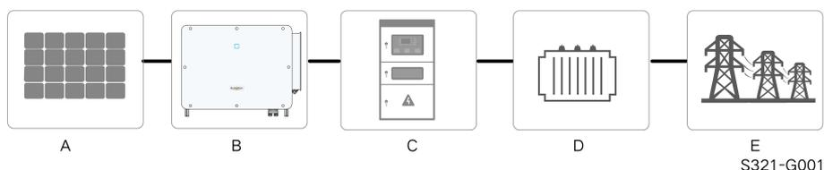
figure 2-1 Application de l'onduleur dans un système d'alimentation photovoltaïque
