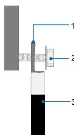
figure 5-4 Branchement du câble en aluminium
