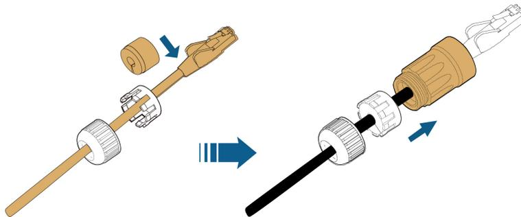
Étape 5 Insérez la fiche RJ45 dans le connecteur de fiche avant jusqu'à ce que vous entendiez un clic et serrez le boîtier. Installez le joint et serrez l'écrou orientable.
