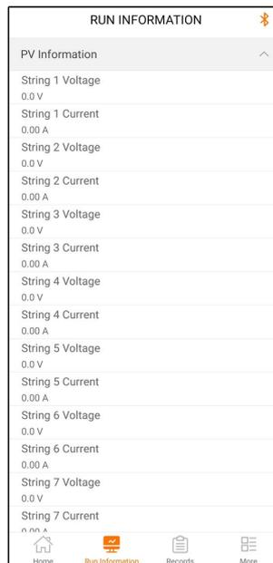
Les informations d'exécution comprennent les informations sur le PV, l'onduleur, l'entrée et la sortie.
