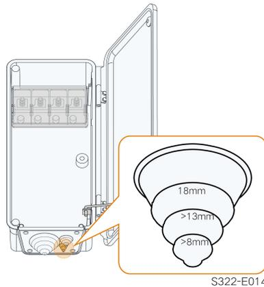
Étape 3 Faites passer le câble à travers la bague d'étanchéité. La longueur du câble non dénudé dans la boîte de jonction CA est de 50 mm.
