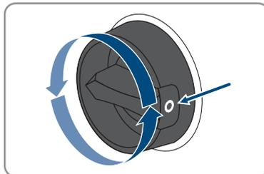
3. Se nel proprio paese viene richiesto che il sezionatore CC sia bloccato contro il reinserimento accidentale, impedire la riattivazione del sezionatore di carico CC mediante un lucchetto.
