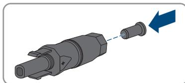
14. Introdurre i terminali CC con i tappi di tenuta nei relativi ingressi CC dell'inverter.
