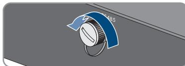
5. Infilare il connettore M12 nella presa per il collegamento di comunicazione RS485 e avvitarlo. Posizionare il connettore in modo che il nasello della presa sull'inverter si infili nella scanalatura del connettore.
