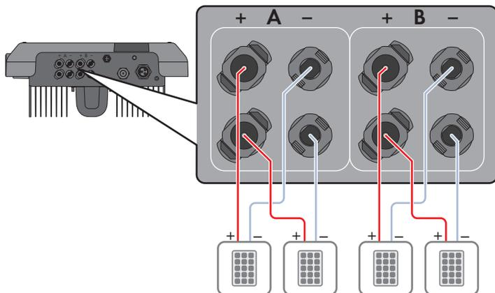
Figura 10: Panoramica del collegamento nel funzionamento normale
