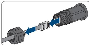
10. Avvitare il cappuccio di protezione alla presa di rete.
