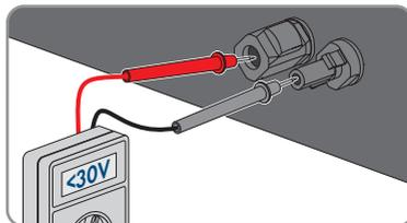
9. Verificare l'assenza di tensione sugli ingressi CC fra il polo positivo e la terra e fra il polo negativo e la terra con un apparecchio di misurazione adeguato.
