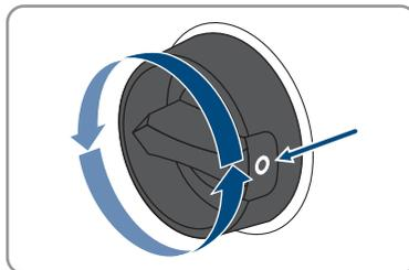
4. Se nel proprio paese viene richiesto che il sezionatore CC sia bloccato contro il reinserimento accidentale, impedire la riattivazione del sezionatore di carico CC mediante un lucchetto.
