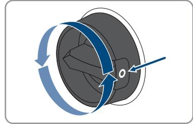
3. Se nel proprio paese viene richiesto che il sezionatore CC sia bloccato contro il reinserimento accidentale, impedire la riattivazione del sezionatore di carico CC mediante un lucchetto.
