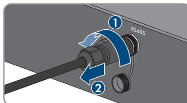
4. Avvitare il cappuccio di protezione alla presa RS485.
