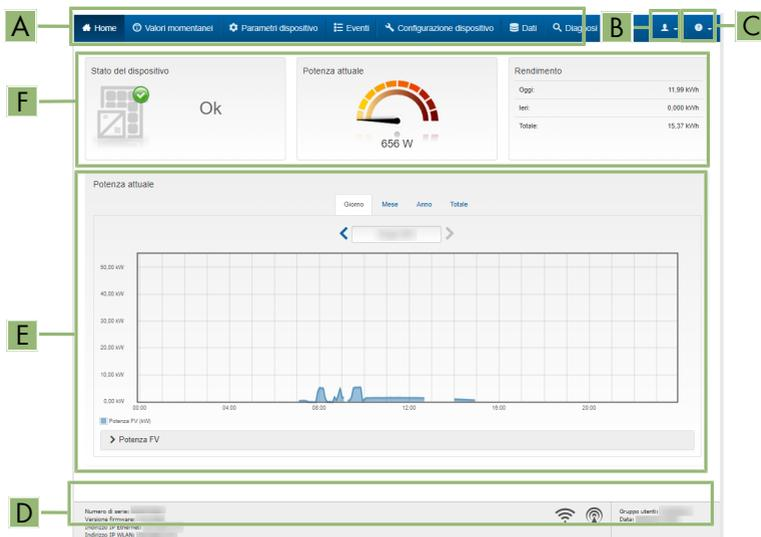
Figura 14: Struttura della pagina iniziale dell'interfaccia utente (esempio)
