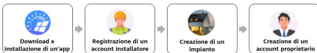
Figura 7-7 Implementazione di un nuovo impianto
