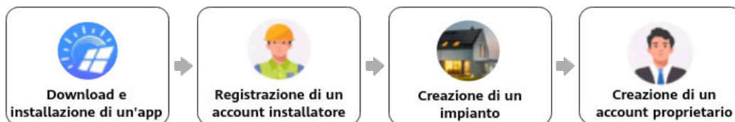
Figura 7-2 Implementazione di un nuovo impianto
