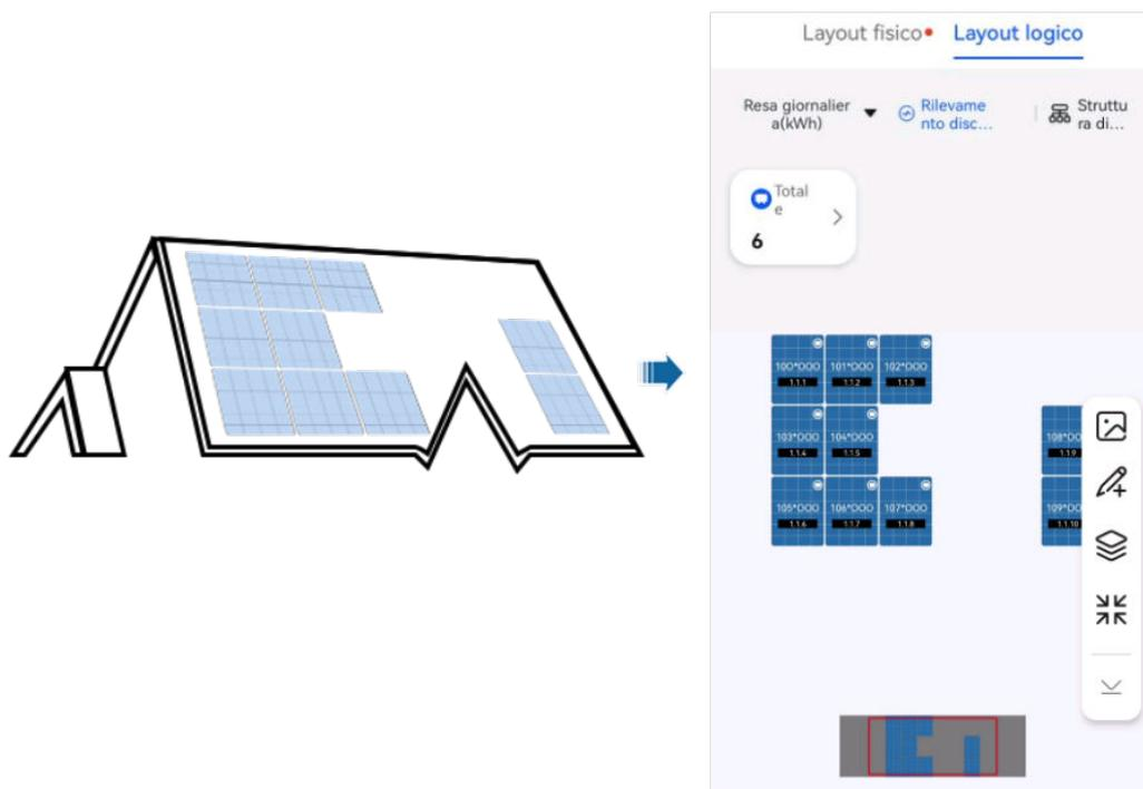
**Figura 7-5** Visualizzazione di un layout fisico su FusionSolar SmartPVMS
