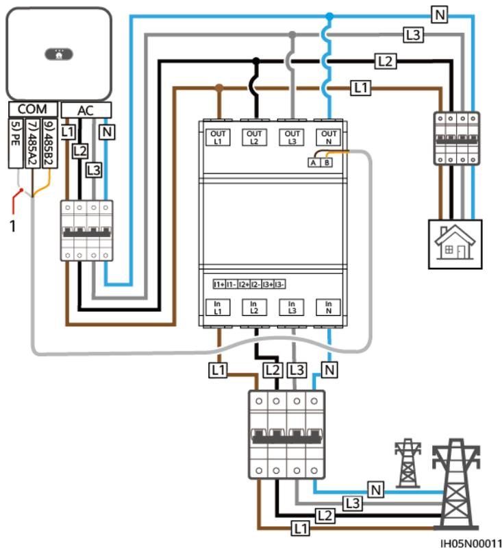
**Figura 5-28** Connessione diretta trifase, tre fili (rete di SmartLogger)
