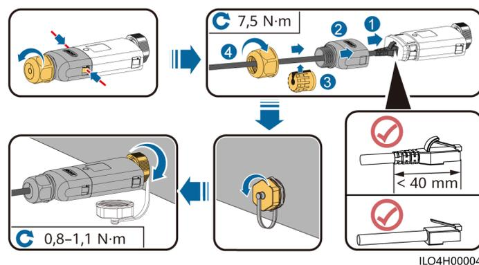
**Figura 5-49** Installazione dei componenti antifurto per Smart Dongle
