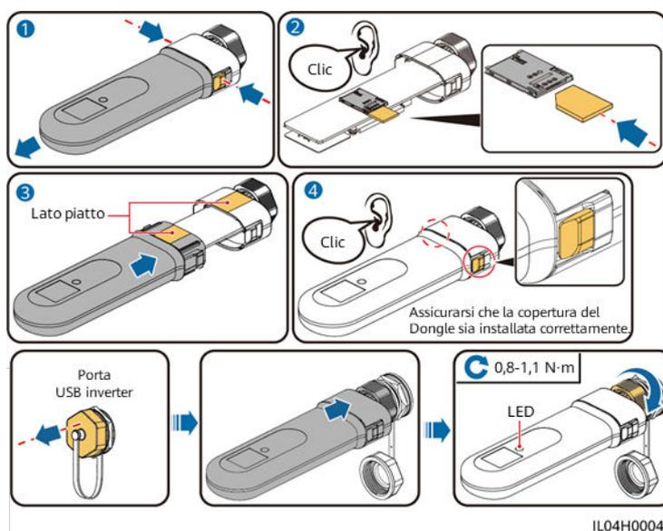
**Figura 5-51** Installazione dei componenti antifurto per Smart Dongle
