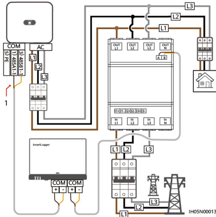
**Figura 5-29** Connessione diretta trifase, quattro fili (rete di SmartLogger)
