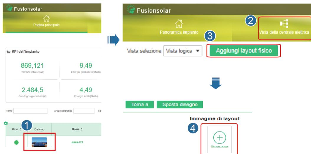
**Passo 2** Accedere all'interfaccia utente Web del sistema di gestione Smart PV FusionSolar. Nella **Pagina principale**, fare clic sul nome dell'impianto per aprire la relativa pagina. Selezionare **Vista della centrale elettrica**. Scegliere **Aggiungi layout fisico** > **+** > **Crea con AI** e creare
