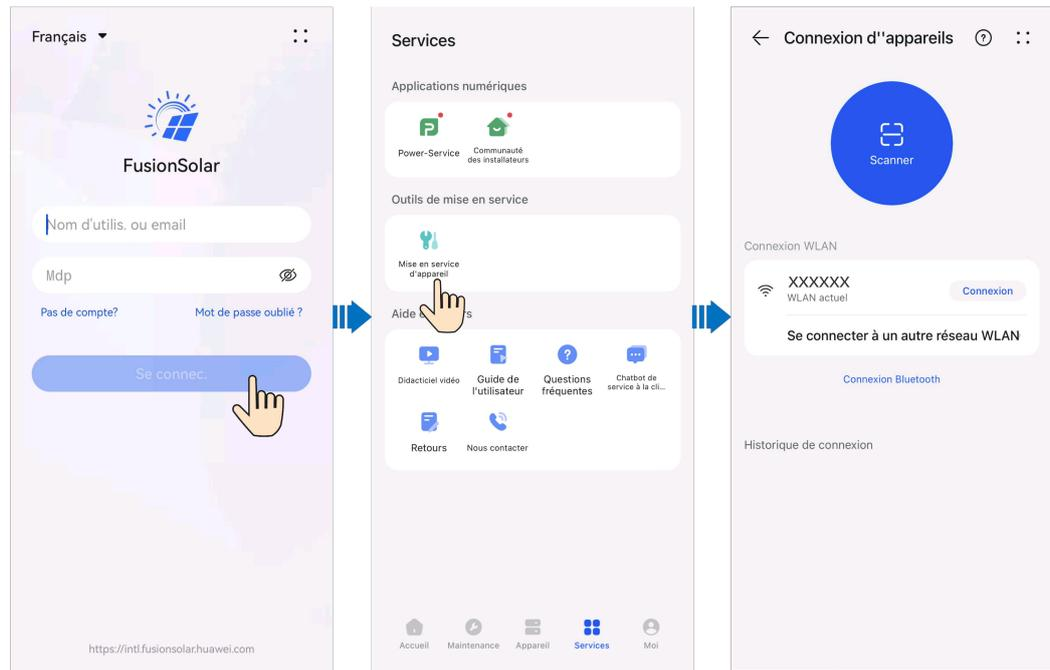
**Étape 2** Connectez-vous au WLAN de l'onduleur solaire et accédez à l'écran Mise en service de l'appareil en tant qu'utilisateur **installateur**.
