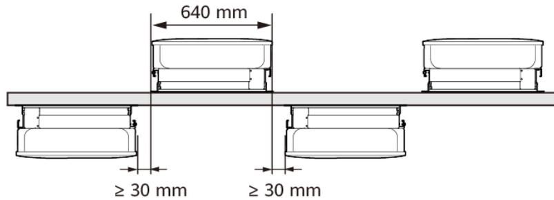
**Figure 4-9** Installation dos à dos sur des supports (non recommandée)
