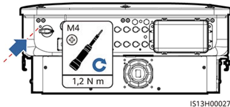
**Étape 2** Installez l'onduleur sur le support de montage.
