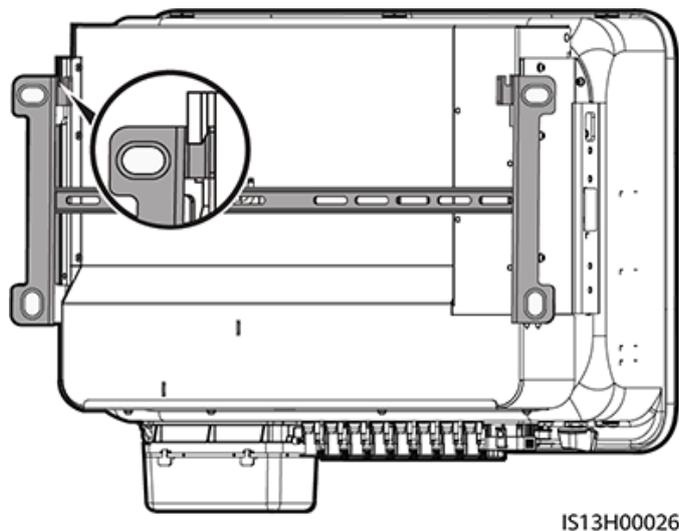
**Étape 3** Serrez les écrous des deux côtés de l'onduleur.
