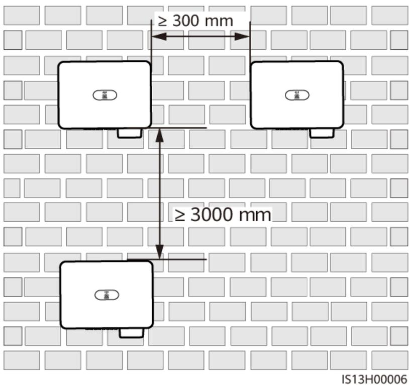
**Figure 4-7** Installation empilée sur des supports (recommandé)
