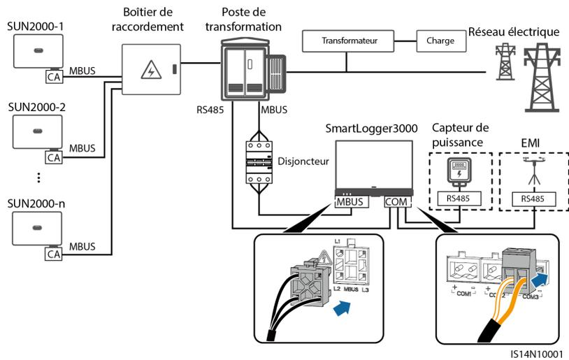
**Figure 5-23** Communication MBUS (scénario C&I en Chine)
