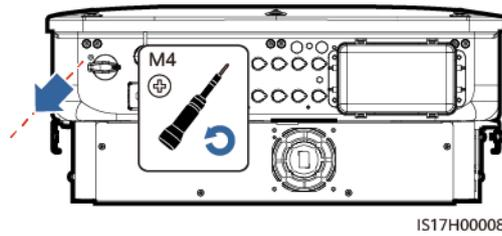
**Étape 3** Réglez le **DC SWITCH** en bas de l'onduleur en position **ON**.
