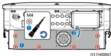
**Étape 2** Retirez l'attache de câble, desserrez le connecteur, débranchez le câble et retirez le ventilateur défectueux.
