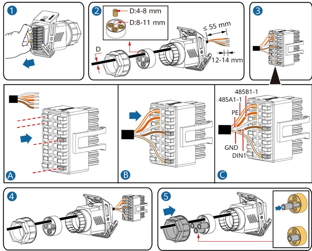
Étape 2 Connectez le connecteur du câble de signal au port COM.
