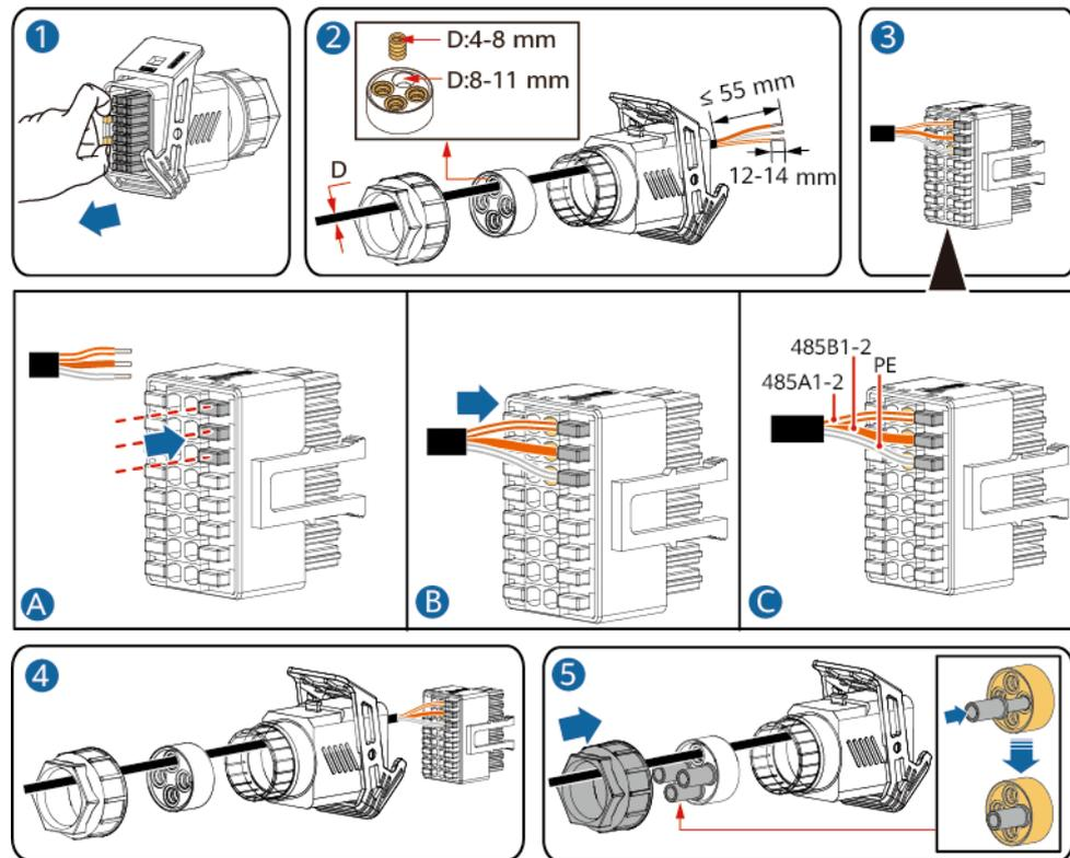
**Étape 2** Connectez le connecteur de câble de signal au port COM.
