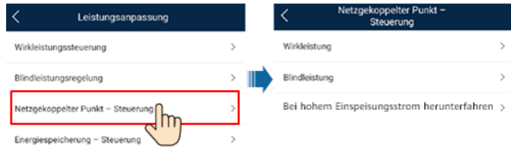
Abbildung 7-5 Netzgekoppelter Punkt – Steuerung
