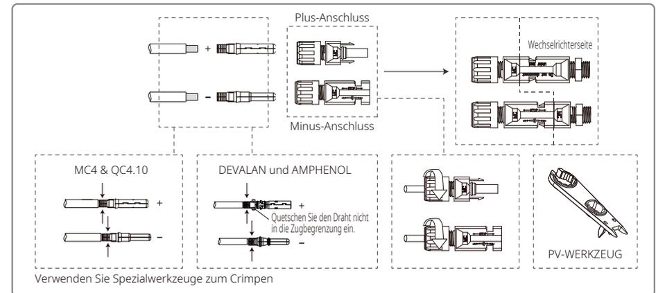
Um den Wechselrichter im Innern besser vor Staub und Wasser zu schützen, sollten alle DC-Verbinder aus der Zubehörtasche an den Wechselrichter angeschlossen werden. Wenn nur ein Teil der DC-Verbinder verwendet wird, ist es ratsam, die offenen DC-Anschlüsse mit Isoliermaterial abzudichten.
