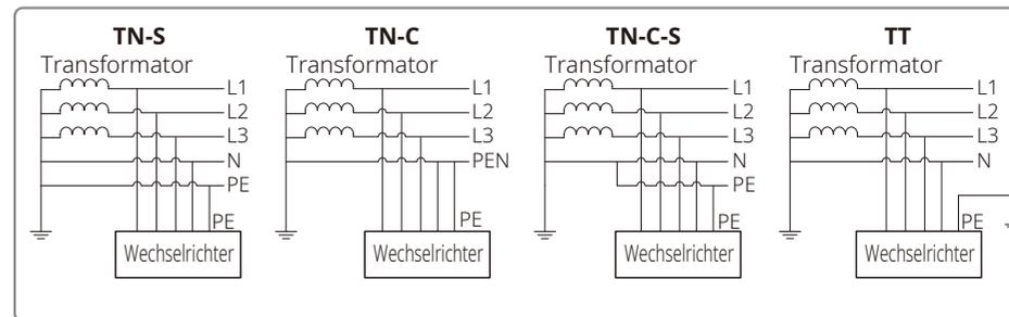
Wenn der Neutralleiter des Wechselrichters nicht an das Netz angeschlossen ist, muss auf der Einstellungsseite für den Netztyp (IT) die Option „Netz in Deltaschaltung“ gewählt werden.
