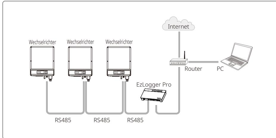
Die RS485-Schnittstelle des Wechselrichters dient zum Anschluss des EzLogger Pro. Die Gesamtlänge des Verbindungskabels darf 1000 m nicht übersteigen.
