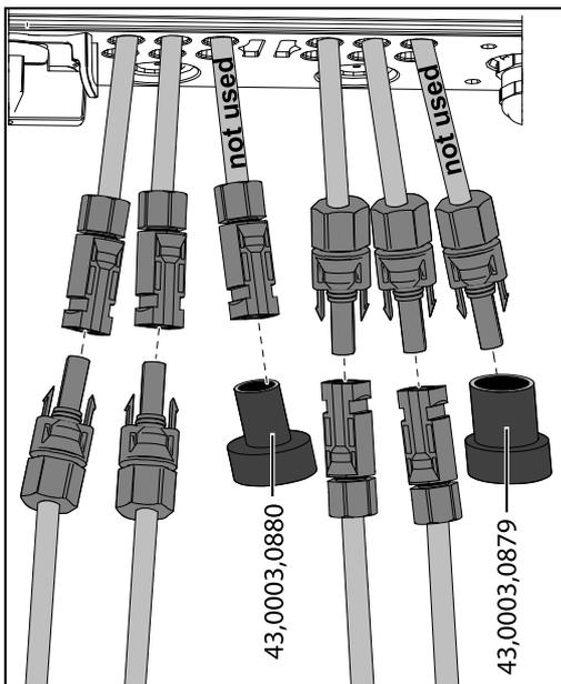
Le spine inutilizzate vanno chiuse con un tappo a vite di copertura. I tappi a vite di copertura si possono ordinare con i seguenti codici articolo:
