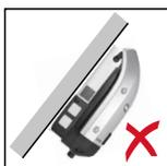
Non montare l'inverter sul soffitto.
