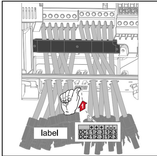
Nella fornitura dell'inverter con l'opzione coppia spina DC +/- MC4 è compreso un adesivo con una panoramica dei cavi. È possibile attaccare questo adesivo in un punto adatto sull'inverter.
