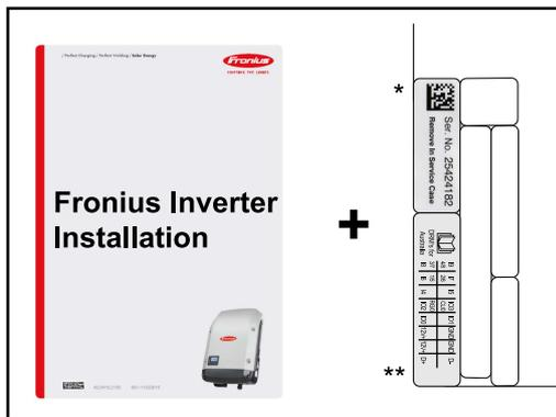
Alle istruzioni d'installazione dell'inverter sono allegati 2 adesivi del numero di serie:
