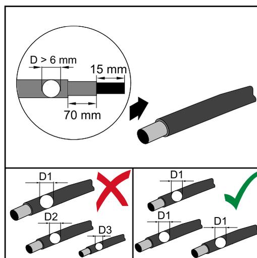
Per i cavi di collegamento CC con doppio isolamento e diametro superiore a 6 mm, occorre rimuovere l'involucro esterno di 70 mm per poter collegare il cavo al morsetto CC.
