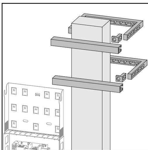
Per il montaggio dell'inverter su un palo o un supporto, Fronius consiglia il kit di fissaggio a un palo "Pole clamp" (N. ordine SZ 2584.000) della ditta Rittal GmbH. Con il kit è possibile montare l'inverter su un palo rotondo o squadrato con il seguente diametro:  $\bar{A}$  da 40 a 190 mm (palo rotondo),  $\bar{y}$  da 50 a 150 mm (palo squadrato).
