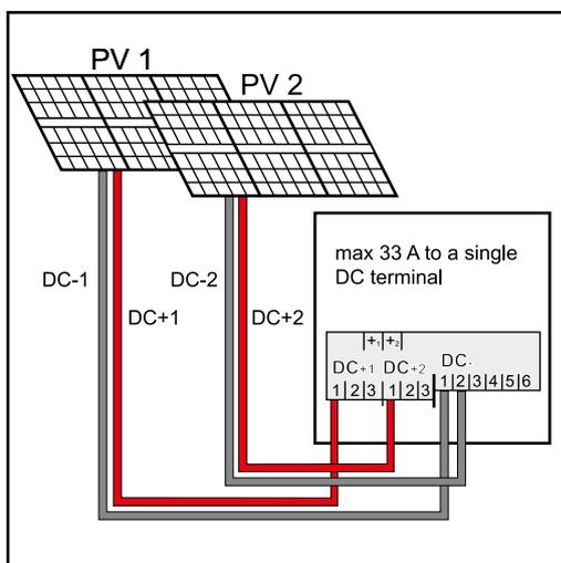
Collegamento di due campi di moduli solari a un inverter con inseguitore MPP multi-
