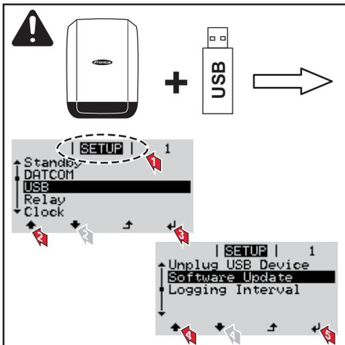
Se l'inverter viene fornito con una chiavetta USB, dopo la messa in funzione dell'apparecchio occorre aggiornare il software:
