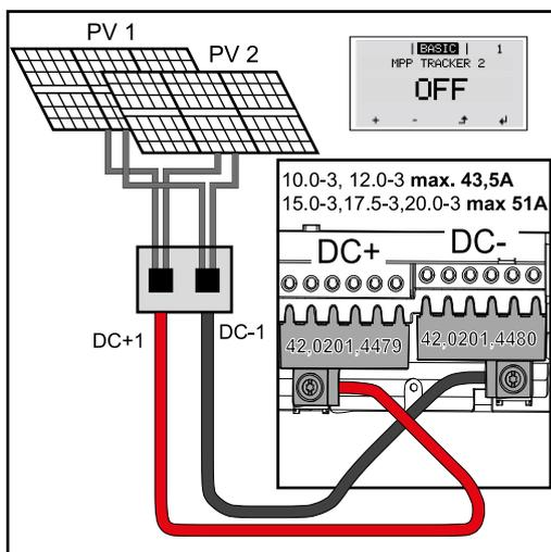
Collegamento di più campi di moduli solari uniti a un inverter con inseguitore MPP multi-
