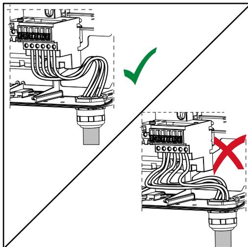
Se si posano i cavi CA sopra l'alberino dell'interruttore CC principale o in obliquo sopra il blocco di connessione dell'interruttore CC principale, i cavi potrebbero danneggiarsi quando si orienta l'inverter oppure potrebbe risultare impossibile orientare completamente l'inverter.
