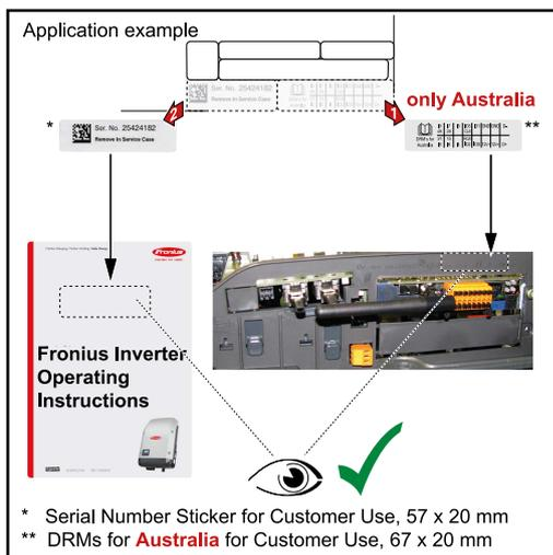
Esempio di applicazione: Adesivo del numero di serie sulle istruzioni per l'uso o sul lato anteriore dell'inverter.
