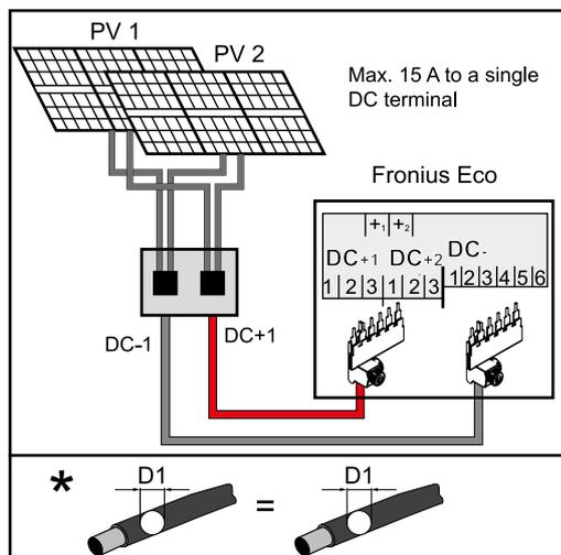
*Collegamento di più campi di moduli solari uniti tramite un cavo*
