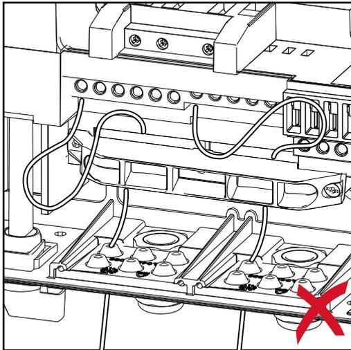
Se si posano i cavi CC sopra l'alberino dell'interruttore CC principale o in obliquo sopra il blocco di connessione dell'interruttore CC principale, i cavi potrebbero danneggiarsi quando si orienta l'inverter oppure potrebbe risultare impossibile orientare l'inverter.
