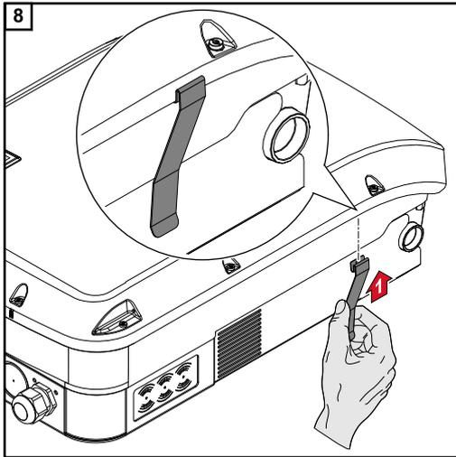
Per Fronius Eco occorre montare sull'apparecchio anche un fermaglio di sicurezza in metallo compreso nella fornitura. Detto fermaglio di sicurezza in metallo è necessario per ottemperare le disposizioni sulla compatibilità elettromagnetica.
