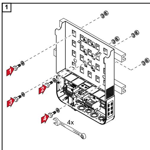
**Non deformare il supporto di montaggio.**
