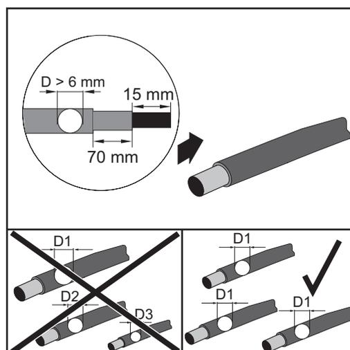
Bei doppelt isolierten DC-Anschlussleitungen mit einem Kabeldurchmesser größer als 6 mm muss die äußere Hülle 70 mm entfernt werden, um das Kabel an der DC-Klemme anschließen zu können.
