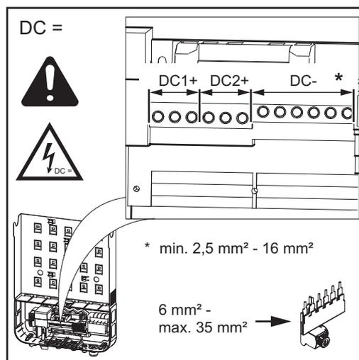
max. Kabelquerschnitt pro DC Kabel:
