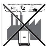
Den Wechselrichter nicht montieren:
