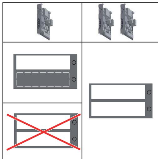
**WICHTIG!** Beim Einbau eines Datamanagers in den Wechselrichter nur eine Öffnung für den Print ausbrechen.
