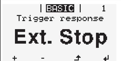
Wechselrichter wird abgeschaltet.
