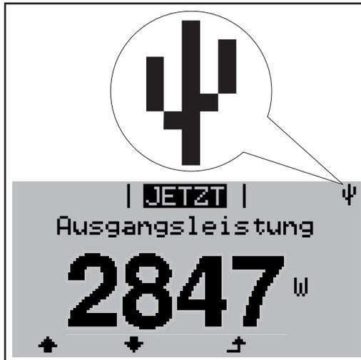
Erkennt der Wechselrichter einen USB-Stick, so wird am Display rechts oben das USB-Symbol angezeigt.
