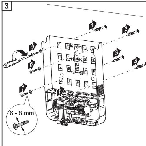
**Montagehalterung auf einem Mast oder Träger montieren**
