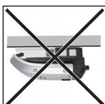
Den Wechselrichter nicht an der Decke montieren.
