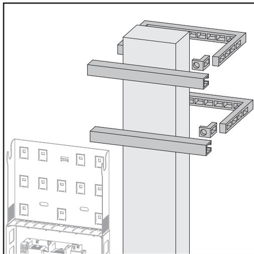
Bei der Montage des Wechselrichters auf einem Mast oder Träger empfiehlt Fronius das Mast-Befestigungsset „Pole clamp“ (Bestell-Nr. SZ 2584.000) der Firma Rittal GmbH.
