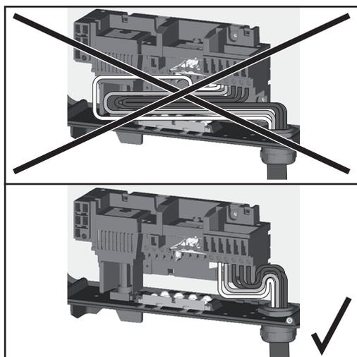
Werden AC-Kabel über die Welle des DC-Hauptschalters oder quer über den DC-Hauptschalter Anschlussblock verlegt, könnten diese beim Einschwenken des Wechselrichters beschädigt werden oder der Wechselrichter lässt sich nicht vollständig einschwenken.
