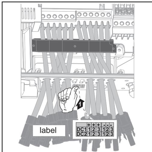
Im Lieferumfang des Wechselrichters mit der Option DC-plug +- pair MC4 ist ein Aufkleber mit einer Kabelübersicht enthalten. Dieser Aufkleber kann an einer geeigneten Stelle am Wechselrichter aufgeklebt werden.
