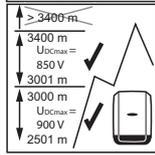
**WICHTIG!** Der Wechselrichter darf über einer Höhenlage von 3400 m nicht mehr montiert und betrieben werden.
