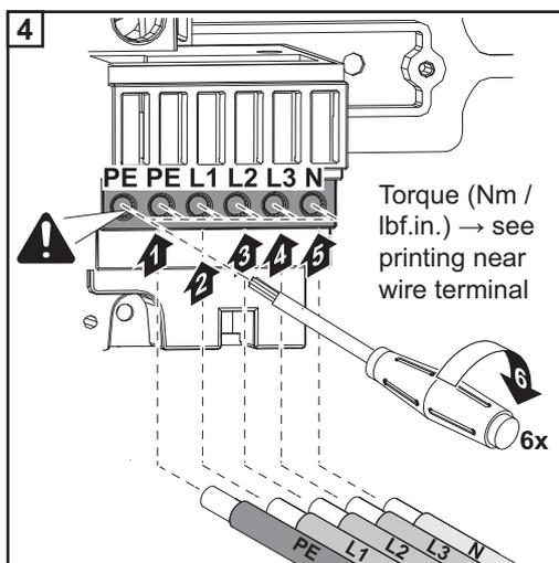
Auch beim nicht belegten Schutzleiter-Anschluss (PE) muss die Befestigungsschraube festgezogen werden.
