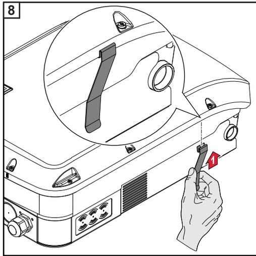
Beim Fronius Eco muss zusätzlich ein im Lieferumfang enthaltener Metallbügel auf das Gerät montiert werden. Dieser Metallbügel ist notwendig um die EMV-Bestimmungen (Elektromagnetische Verträglichkeit) einzuhalten.
