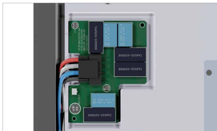
Fig. 4.4: Scaricatori di sovratensione CA
