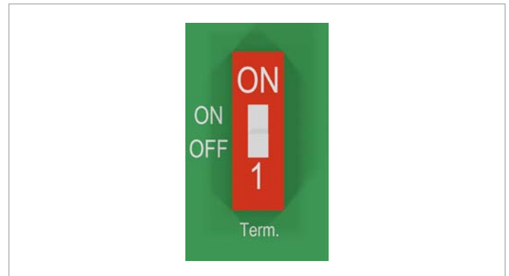
Fig. 7.3: Interruttore DIP per resistenza terminale RS485
