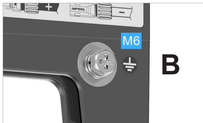
Fig. 4.15: Collegamenti di terra sul piede destro dell'inverter
