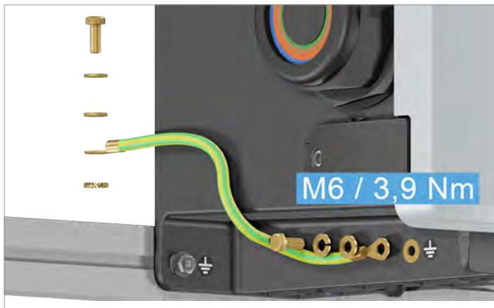
1. Visser le câble de mise à la terre sur la partie inférieure gauche de l'onduleur (couple : 3,9 Nm). Pour cela, une vis M6, une rondelle élastique et une rondelle plate sont nécessaires. Aucune rondelle dentée **n'est** requise.
