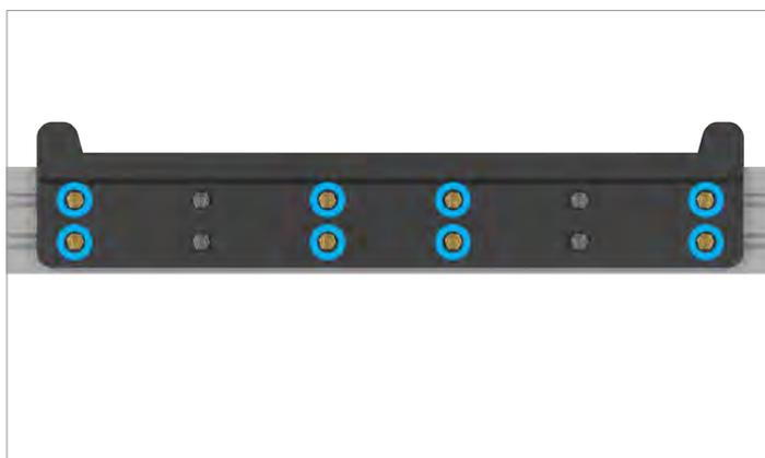
1. Fixer la plaque de montage sur le mur ou le système de montage en utilisant au moins 8 vis M6.
