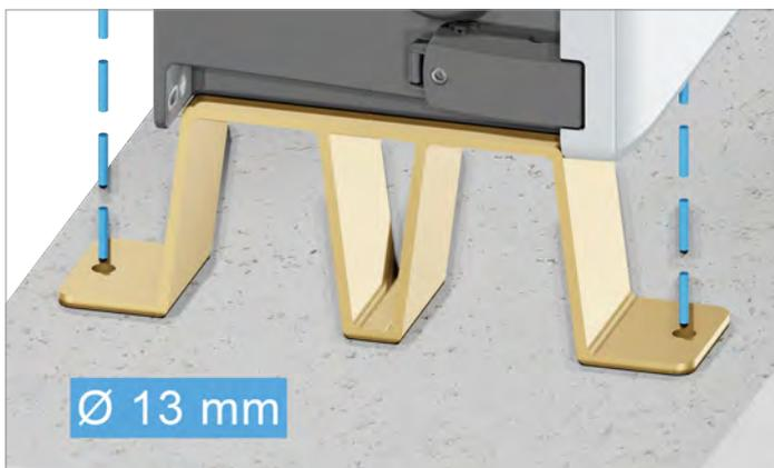
2. Placer l'onduleur perpendiculairement à la surface de montage et visser les 2 pieds sur la surface de montage.
