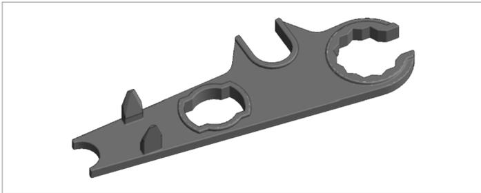
Fig. 8.16 : Clé de montage pour fiche DC (incluse dans la livraison)
