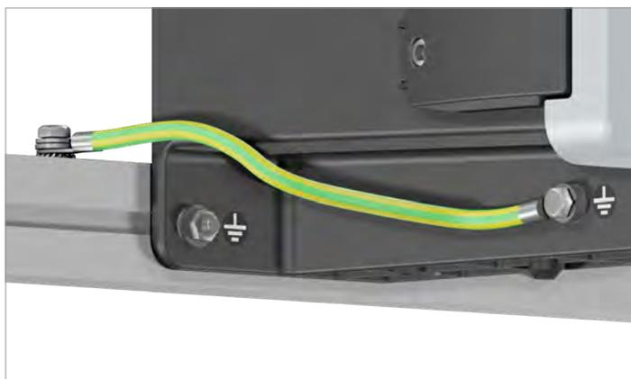
2. Effectuer un contrôle de continuité du raccord de mise à la terre.
