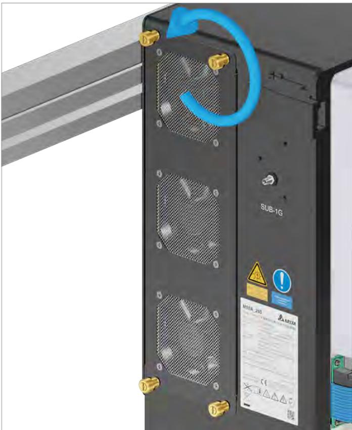
1. Dévisser et déposer le module de ventilation.
