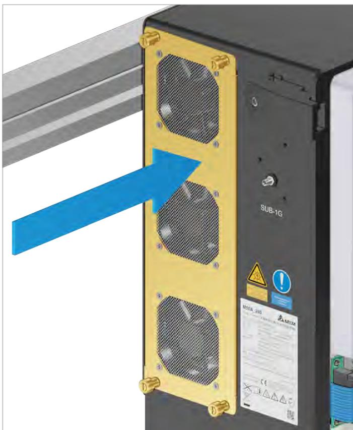
5. Insérer le module de ventilation de manière à ce que les câbles d'alimentation électrique se trouvent sur le côté droit du module de ventilation.
