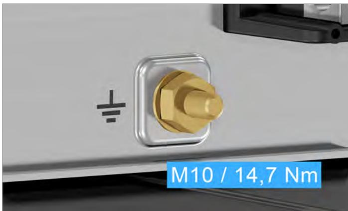
1. Visser le câble PE/PEN sur la vis PE (couple de serrage : 14,7 Nm). Écrou M8, rondelle élastique et rondelle plate disponibles.
