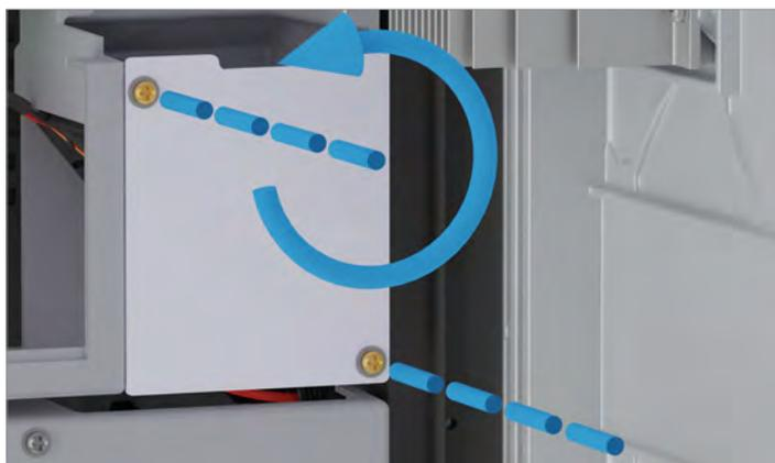
3. Dévisser et déposer le couvercle. Le ventilateur est vissé fermement au couvercle.
