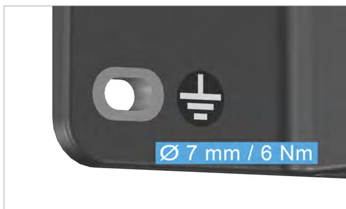
Fig. 6.14 : Raccord de mise à la terre au niveau du trou de fixation gauche
