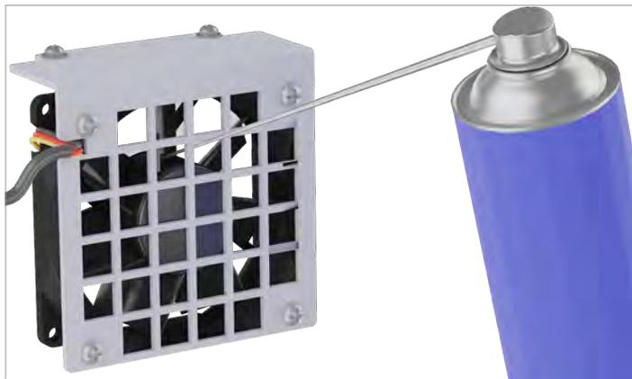
4. Nettoyer le ventilateur et le boîtier métallique avec de l'air comprimé ou un pinceau solide.
