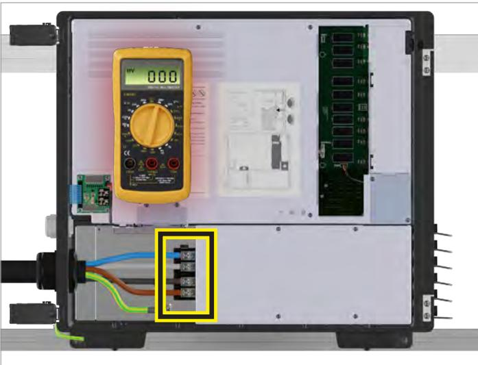
10. Vérifier avec un voltmètre que le bornier AC est hors tension.
