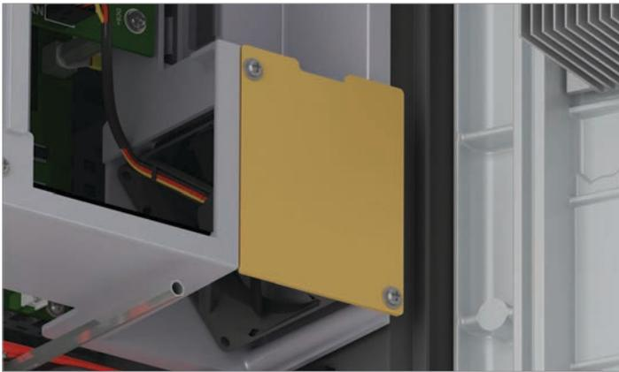
Fig. 4.19: Position of internal fan 2
