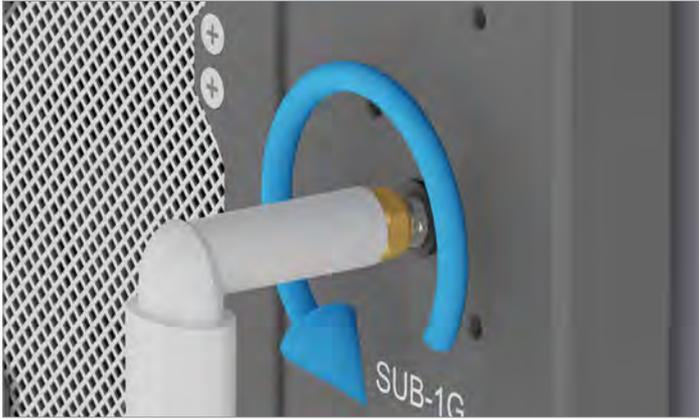
4. Die Sub-1G-Antenne abschrauben und entfernen.
