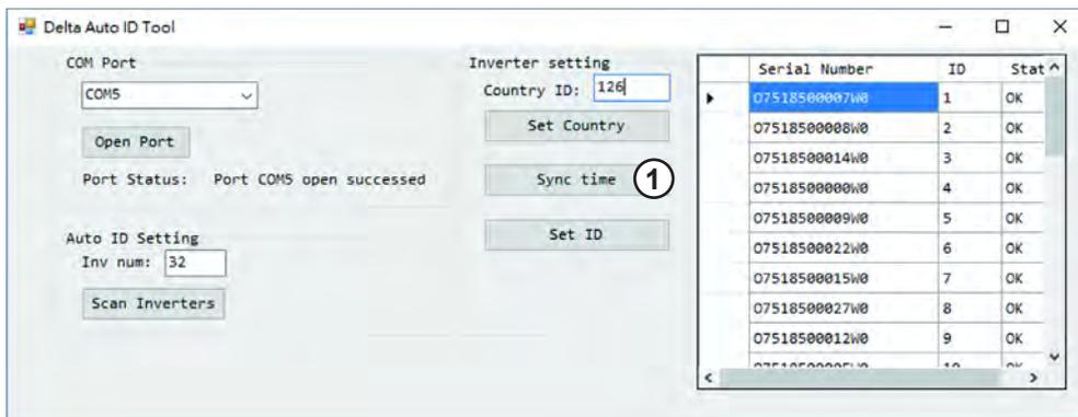
7. Um Datum und Uhrzeit für alle Wechselrichter einzustellen, auf die Schaltfläche **Sync time (Zeit synchronisieren)** klicken (1).
