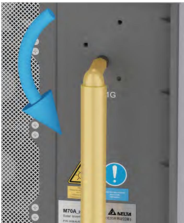
6. Die Sub-1G-Antenne nach unten drehen.
