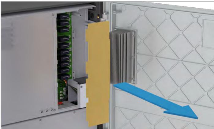
4. Die Abdeckung der DC-Überspannungsableiter entfernen.
