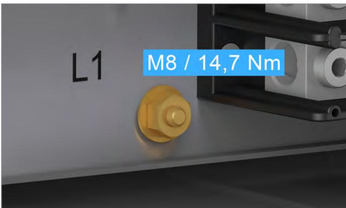
Abb. 5.12: PE-Schraube im Inneren des Wechselrichters
