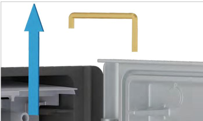
3. Den Sechskantschlüssel oben aus der Tür entfernen.
