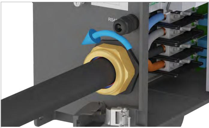
12. Die AC-Kabelverschraubung abschrauben.
