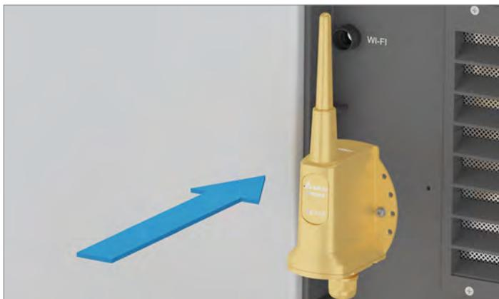
1. Die Kabelverschraubung des Wi-Fi-Anschlusses abdrehen und Kabelverschraubung und Dichtung entfernen.
