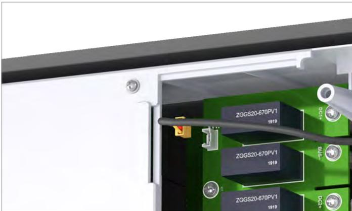
2. Das Kabel des Wi-Fi-Moduls am oberen Ende der Karte mit den DC-Überspannungsableitern herausziehen.
