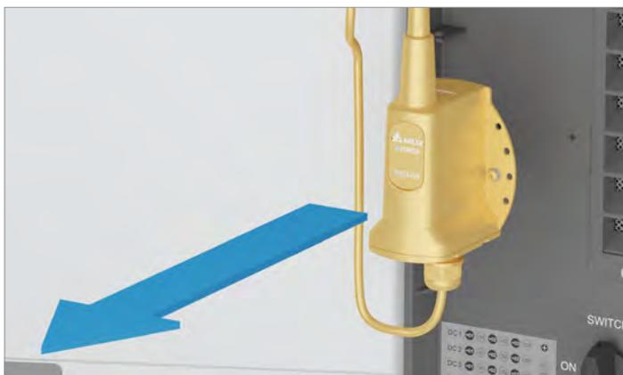
3. Die Kabelverschraubung des Wi-Fi-Anschlusses abdrehen und Kabel, Kabelverschraubung sowie Dichtung herausziehen.
