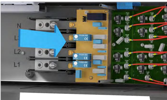
4. Die neue Leiterplatte einsetzen und alle Schrauben der Leiterplatte anziehen.
