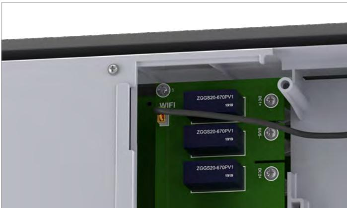
5. Das Kabel in den Stromversorgungsanschluss auf der Leiterplatte mit den DC-Überspannungsableitern stecken..
