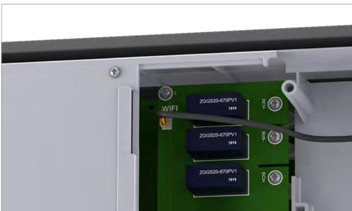
3. Das Kabel durch Kabelverschraubung und Dichtung ziehen.
