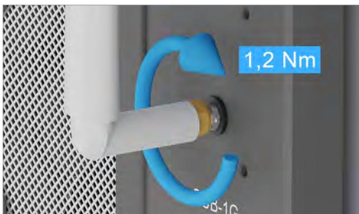
5. Die neue Sub-1G-Antenne aufsetzen und soweit anschrauben, dass sie noch drehbar ist.
