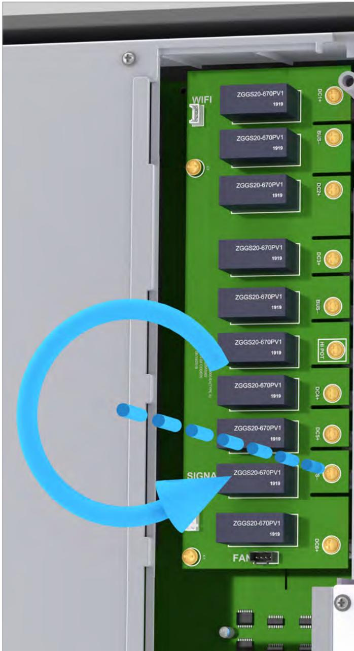
5. Alle Schrauben der Leiterplatte lösen und die DC-Überspannungsableiter Typ 2 herausnehmen.
