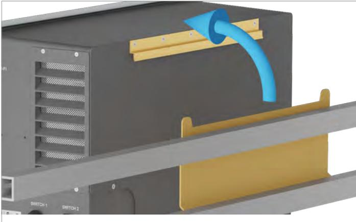
3. Den Wechselrichter aus der Montageplatte heben und in die Box des Austauschgeräts legen.
