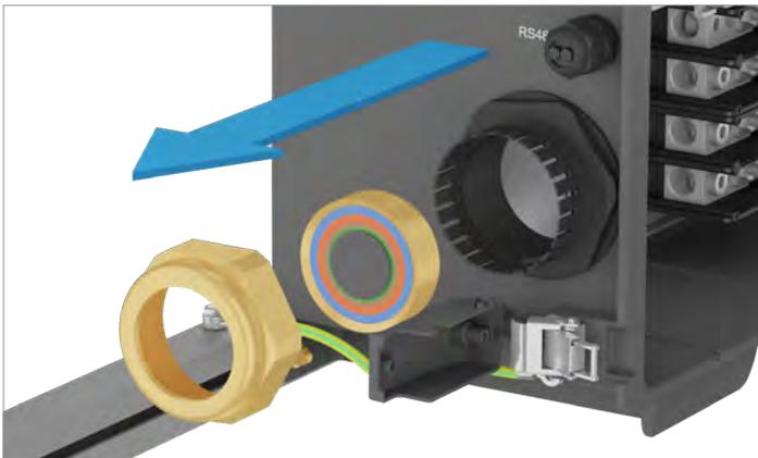
2. Das AC-Kabel durch Kabelverschraubung und Dichtung ziehen.
