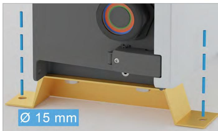
1. Die 2 Standfüße für die Bodenmontage an der Unterseite des Wechselrichters festschrauben (Drehmoment: 24,5 Nm). 4 Schrauben, Federring und Unterlegscheibe sind im Lieferumfang der Standfüße enthalten.
