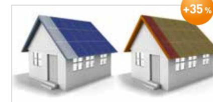
**Module in Standardgröße** können das Dach nicht vollständig in seiner Breite abdecken. **Das schmale N245 Modul** passt perfekt in den verbleibenden engen Raum.
