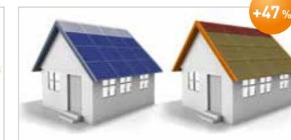
**Module in Standardgröße** können das Dach in seiner Breite abdecken, aber nicht in seiner Höhe. **Das schmale N245 Modul** passt perfekt in den verbleibenden engen Raum.
