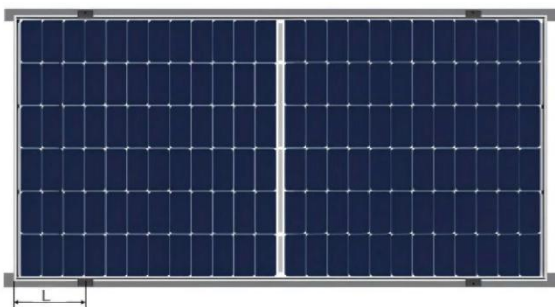
Montage mit Klemmen Montageschienen quer zum langen Rahmen (Methode 5)
