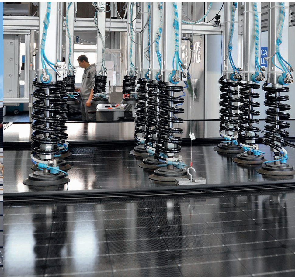
Test de la charge de pression des modules et des cadres effectué au SUPSI
