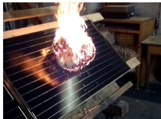
Abbildung 1: Prüfung Widerstand gegen Flugfeuer und strahlende Wärme
